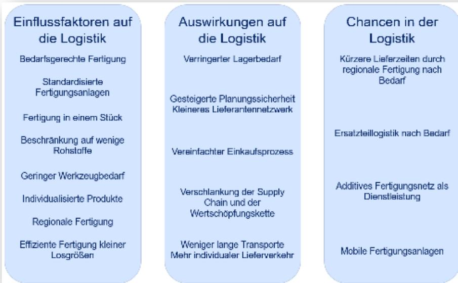
Abbildung 2: Einflussfaktoren, Auswirkungen und Chancen der additiven Fertigung bezogen auf die Logistik.
