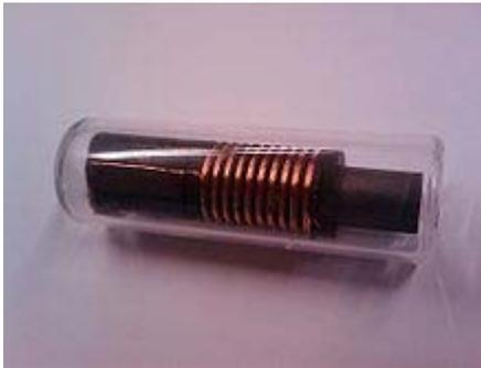
125-kHz-Transponder mit Spule auf Ferritkern
