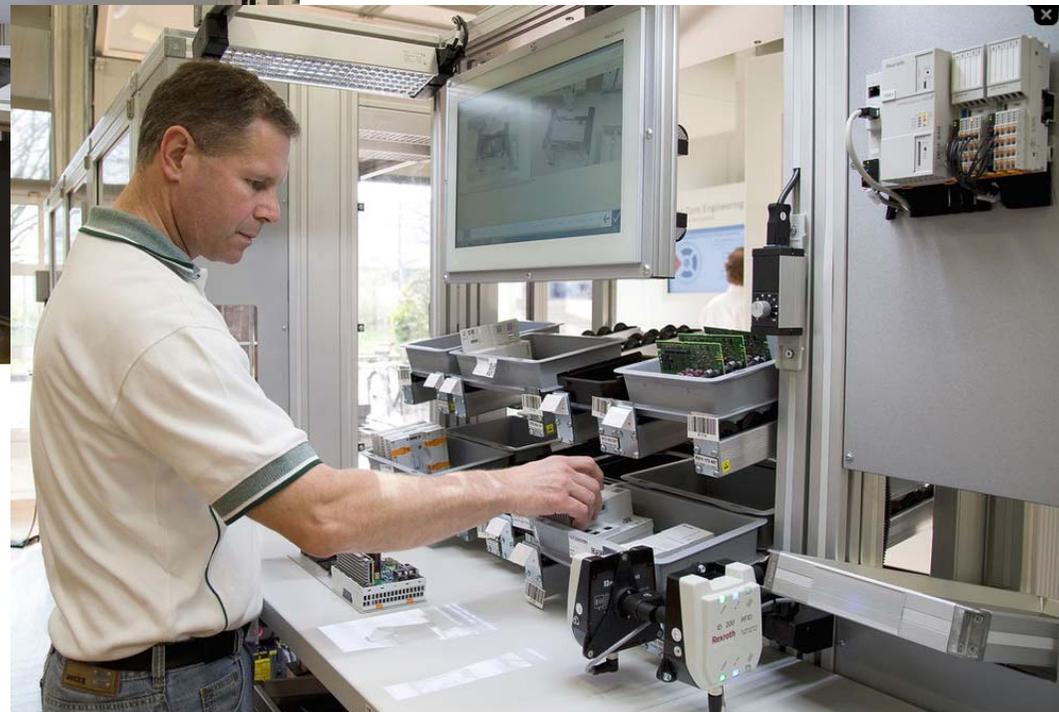
Das Assistenzsystem Activeassist soll den Mitarbeiter am manuellen Arbeitsplatz bei der variantenreichen Montage unterstützen. (Bild: Bosch Rexroth)
