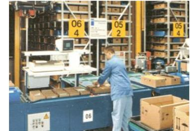
Beim Ware-zur-Person-Prinzip wird die Ware zu einem Kommissionierplatz transportiert. Nach der Entnahme werden Restmengen wieder zurückgelagert.
