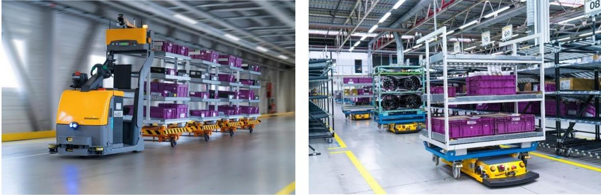
Abb: Routenzüge und FTS für die Montageversorgung
