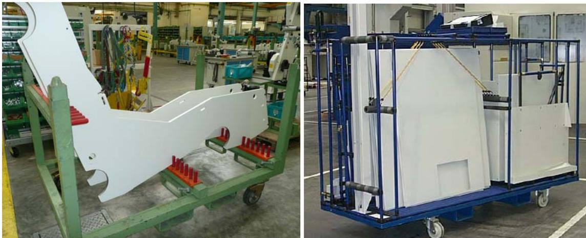
Bilder 25 und 26: Spezielle auftragsbezogene Transportwagen für sperrige Teile, satzbezogene Anlieferung
