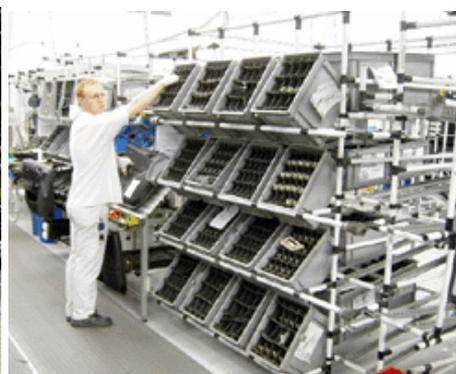
Bilder 23 und 24: Farbliche Behältnisse zur Unterscheidung von Teilen und Varianten / Einsehbare Behältnisse
