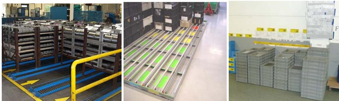
Bilder 16 - 18: Visuelle Darstellungen der aktuellen Materialsituation (FiFo-Bahnhof, Kanban-Linie; Min.-max.-Anzeige)
