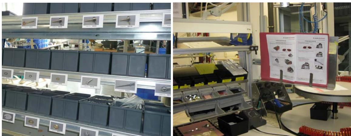
Bilder 19 und 20: Visualisierung durch Teilenummern und Photo; Visualisierung des aktuellen Montagevorgangs
