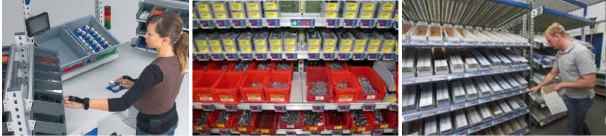
Bilder 54 bis 56: 3D-Trackingsystem zur geführten Montage und Pick-to-light-Kommissionierungen
