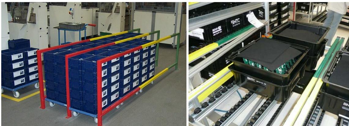
Bilder 32 und 33: Signal-Farben in der FiFo-Bahn / Signalfarbe und standardisierte Behälter vor der Linie
