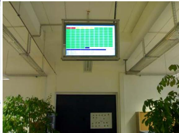
Bilder 64 und 65: Visualisierung von Maschinenzuständen für den schnellen Eingriff der Instandhaltung bei Maschinenstillständen
