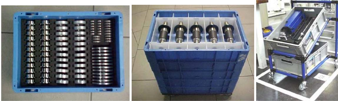
Bilder 29 bis 31: Anlieferungsbeispiele für Pull-orientierte Einzelsatzanlieferung
