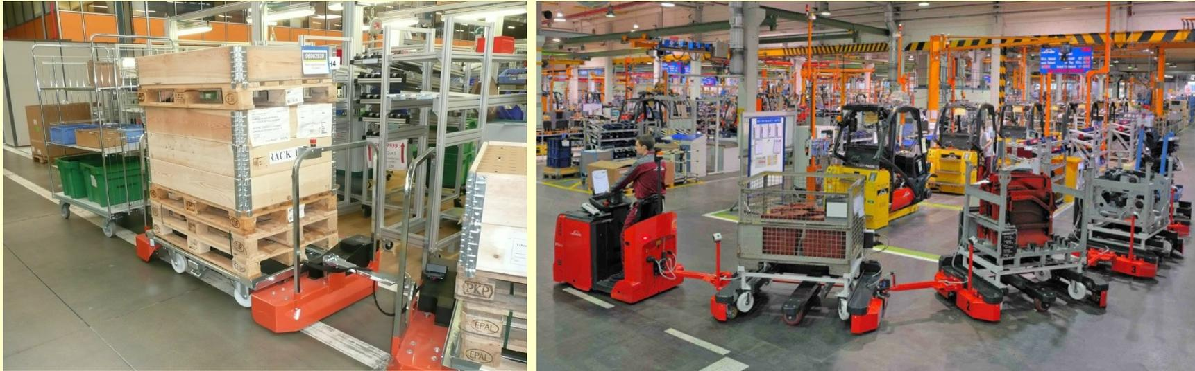
**Ein Logistikzug** ist in der Horizontalen beim Be- und Entladen von Lkw, dem Verteilen der Ware und der Ladungsgüter sowie deren Einlagerung in Regale oder Blocklager geeignet. Ferner beim Transport in den Kommissionierbereich beziehungsweise zu den Produktionsstätten oder zu den Supermärkten, wo die Produktionsgebilde vorbereitet werden, um in passender Stückzahl und Konfiguration ans Band angeliefert zu werden.
