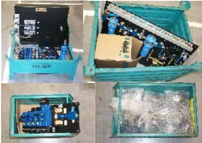
Anlieferung der Anbindung Laserkonsole, Pneumatikplatte, Gasplatte, Geräteblech vorne in einzelnen Schäferkisten aus WII. Flächenbedarf 1,63m<sup>2</sup>
