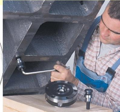
Direkte Werkstückspannung. Der Spannbolzen wird im Werkstück verankert.
