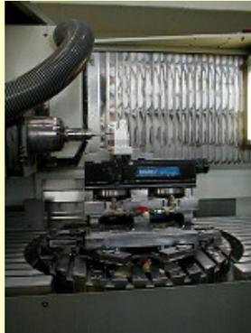
NC-Schnellspanner mit Unterbau und horizontaler Bearbeitung
