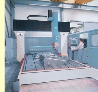
In den Maschinentisch sind insgesamt 32 Module eingebaut und können über die Maschinensteuerung entriegelt werden.
