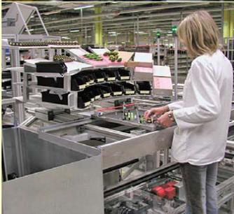
Anstelle von Lagerlisten oder Datenfunkterminals trägt der Kommissionierer einen für die Kommissionierung optimierten Kopfhörer mit Mikrofon, der an einen mobilen Computer angeschlossen ist. Der komplette Kommissioniervorgang wird durch Sprache gesteuert. Das System PickTerm Voice nutzt eine vom Sprecher unabhängige Spracherkennung, was bedeutet, dass keine Einlernzeiten anfallen. Das System ist sofort einsatzbereit. Das Pick by Voice-Prinzip empfiehlt sich z.B. für ausgedehnte Lagerbereiche.
