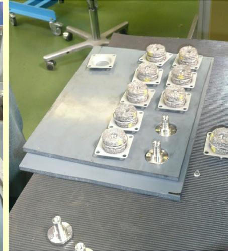
One-piece-flow stößt da an Grenzen, wo manuelle Eingriffe nötig werden. Z.B. beim Zusammenfügen verschiedener Teile durch verschrauben, vernieten, verkleben, etc. Im One-piece-flow wird der Hand-Schrauber im linken Bild normalerweise bei jedem Teil Entnommen und wieder in seine Ausgangsposition gebracht. Durch eine Vierfach-Vorrichtung wird dieser Handriff einmal für vier Teile ausgeführt.
