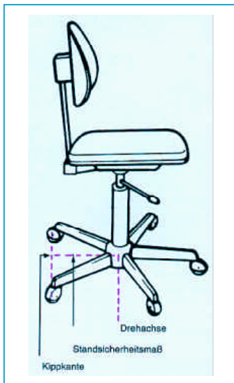
Bild 11-1: Arbeitsstuhl; Erläuterung des Standsicherheitsmaßes
