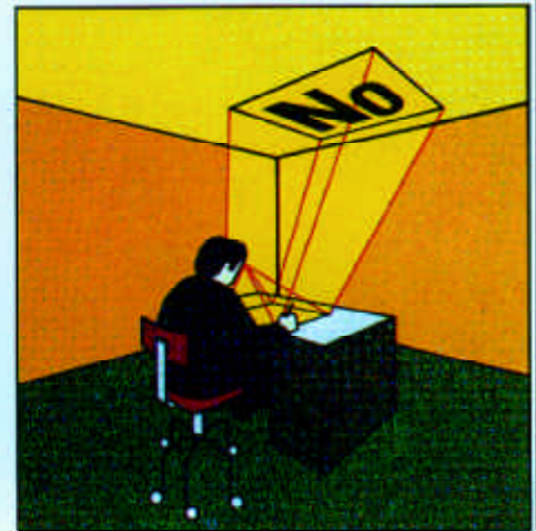
Bild 19-6: Blendung durch zu hohe Unterschiede der Leuchtdichten im Blickfeld
