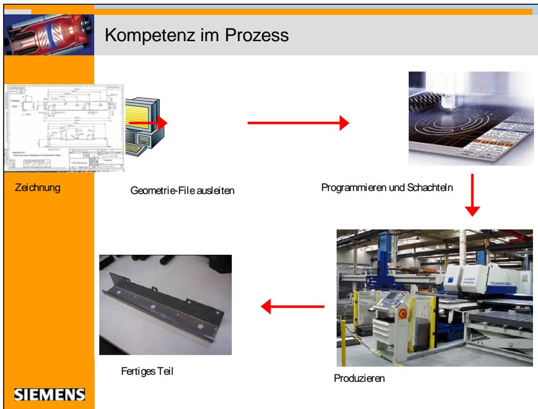
Bild 6: Programmierung im Prozess Spanlose Fertigung
