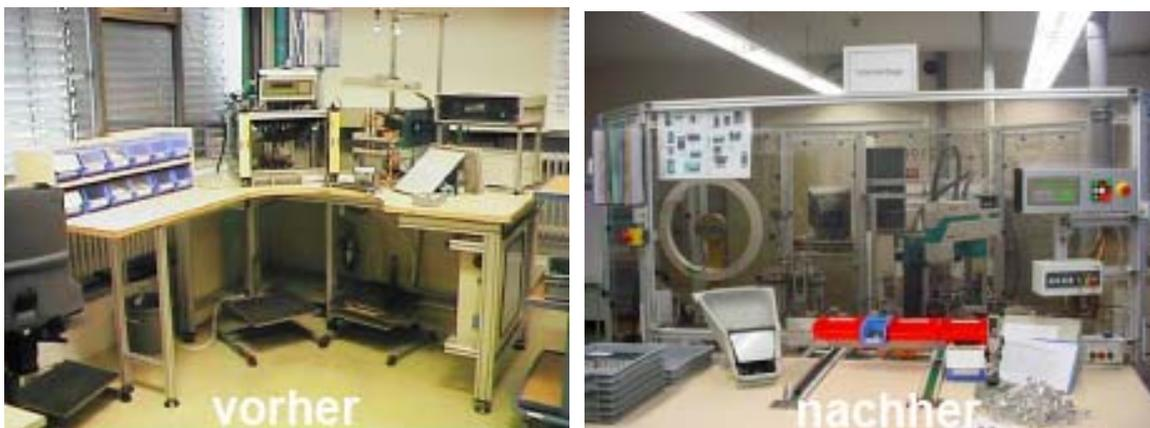
**Bild 10: Inselfertigung mit automatischer Spulenfertigung und Rundtisch-Montage**
