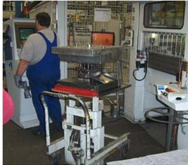
**Bild 107: Höhenverstellbarer Werkzeugwagen für schnellen Ein- und -Ausbau**
