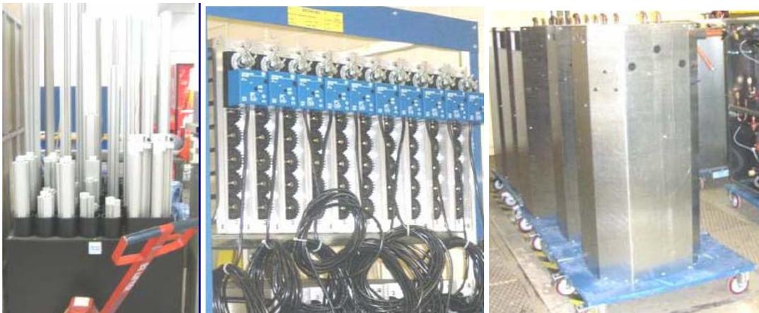
**Bild 141:** Set-Anlieferung (Set = ein Kanban) durch externen Lieferanten (einbaufertige Profile), Baugruppen-Kanban durch interne Lieferanten
