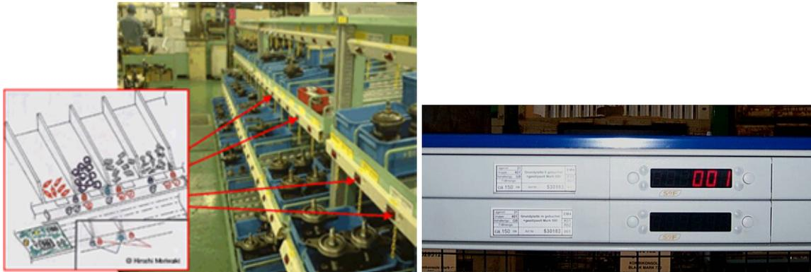
Bild 103: Pick-to-Light zur Vermeidung falscher Material Entnahmen (Quelle: Synchro AG, vgl. /24/)
