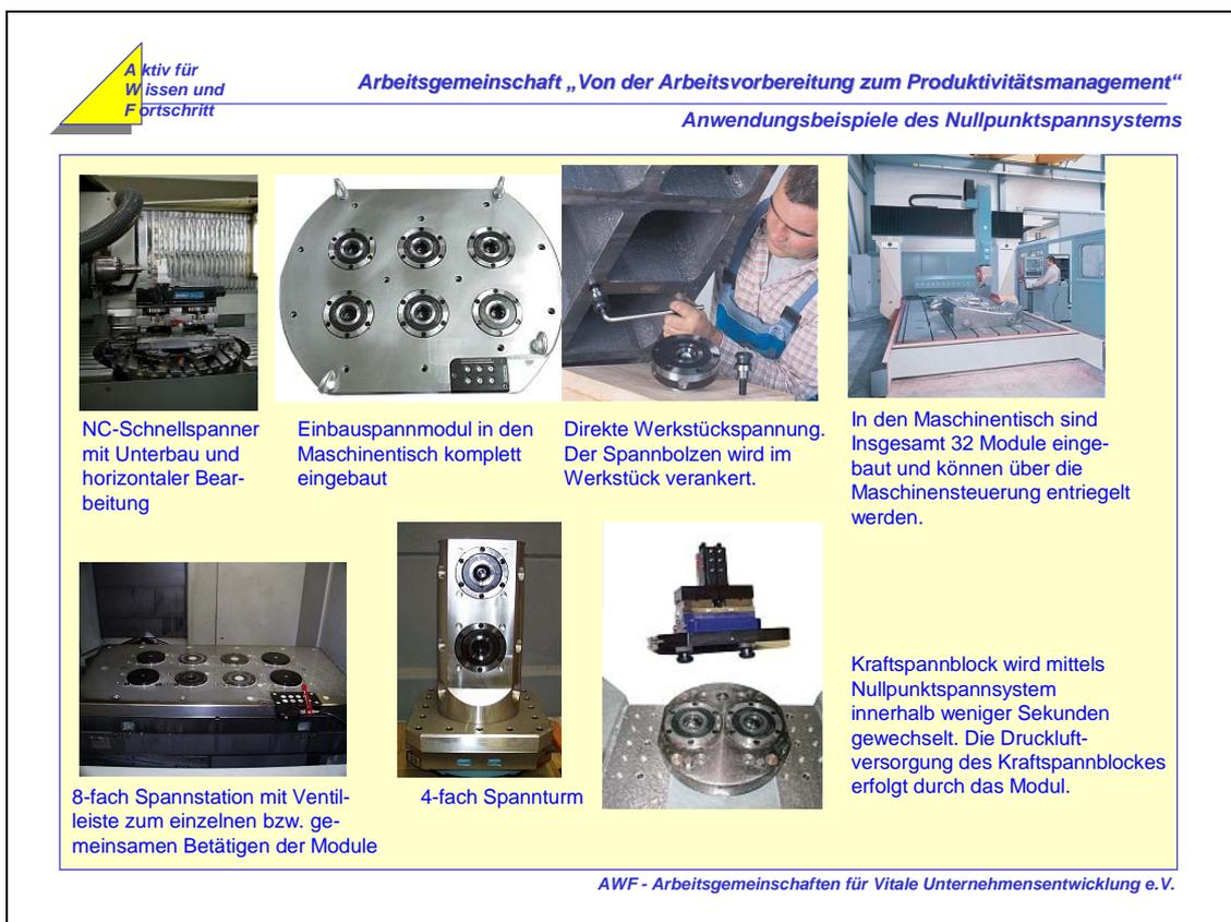
**Bild 104:** Beispiele für Anwendungen des Nullpunktspannsystems (Quelle: Andreas Maier Fellbach GmbH)
