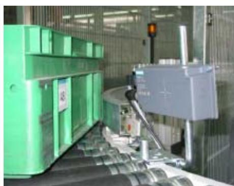
**Bild 54: RFID-Lesegerät, RFID-Chip auf dem Behältnis**
