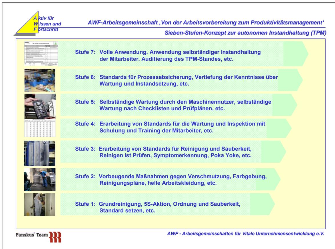
**Bild 124:** Sieben-Stufen-Konzept zur produktivitätsorientierten Instandhaltung (TPM)
