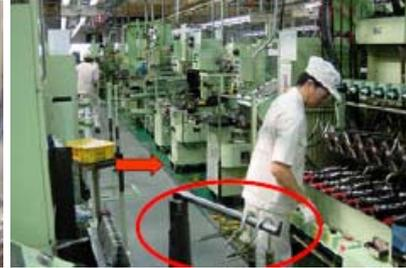
Bild 150: Schwenkarm für Teilewechsel
