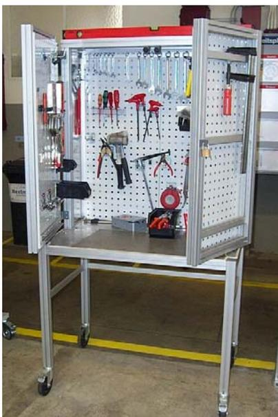
Bild 99a: Werkzeugwagen für den schnellen KVP
