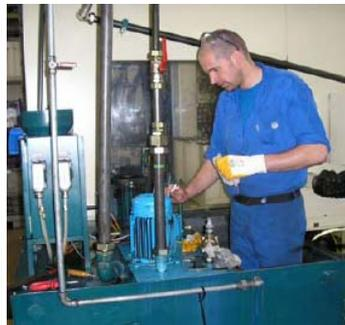
**Bild 122: Regelmäßiges Öffnen und Reinigen der Elektromotoren**
