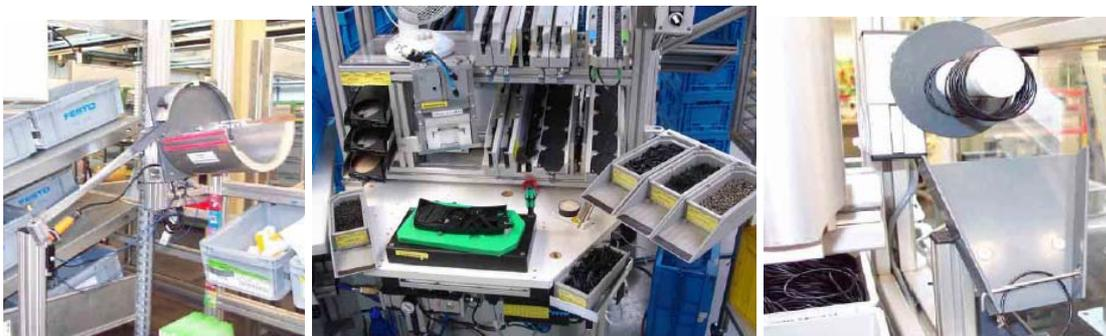
**Bild 143: Beispiele für einfache Materialzuführungen (Quelle: /23/)**
