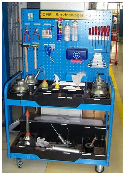
Bild 99b: Werkzeugwagen für die vorbeugende Instandhaltung (TPM)
