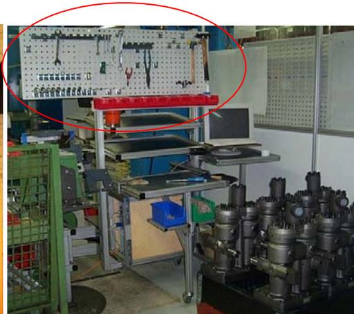
**Bild 83: Werkzeugboard mit fehlenden Werkzeugen und zugestellter Arbeitsplatz**
