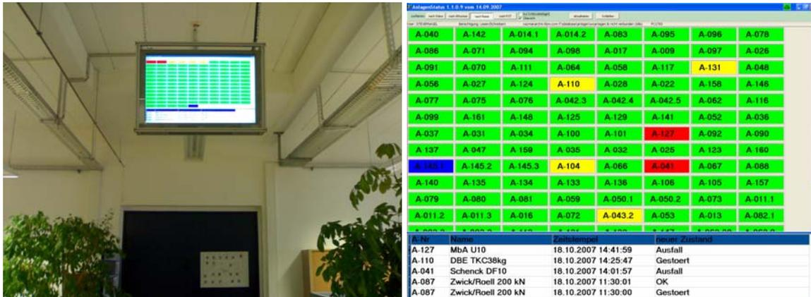
Bild 125: Monitor zur Überwachung und Anzeige des Status der Maschinen und Anlagen
