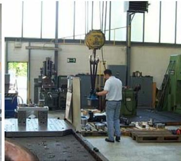
**Bild 108: Bodenlagerung von Vorrichtungen und Material mit zeitaufwendigen Kranbewegungen**
