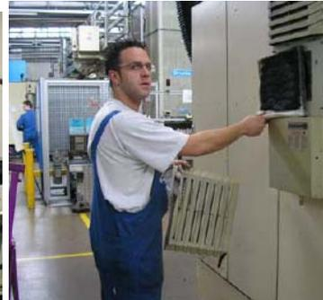
**Bild 123: Regelmäßiges Kontrollieren und Austauschen der Filtereinlagen**
