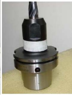
Bild 114: Codiertes Werkzeug mit Chip-leser in der Maschine
