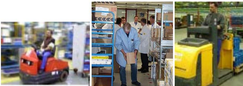
Bild 137: „Taumelkäfer“, Kanban-Zug, Kommissionierer für die Materialzu- und-abführung
