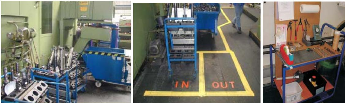
Bild 112: Werkzeugbereitstellung vor und nach einer 5S-Aktion, Einsatz eines „offenen“ Rüstwagens
