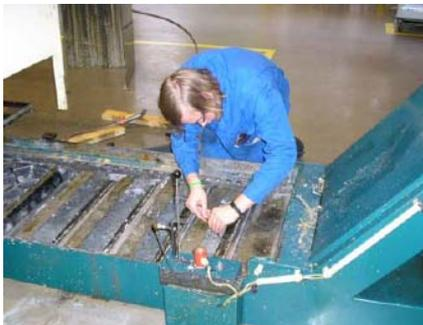
**Bild 121: Regelmäßiges Reinigen der Kantspaltfilter**
