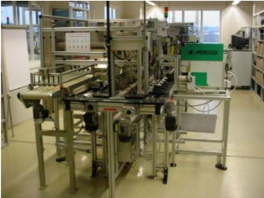
Bild 8: Verkettete und automatisierte Arbeitsabläufe
