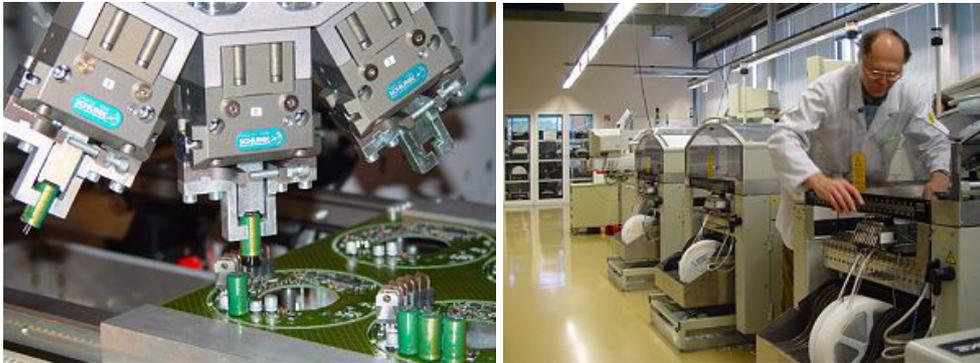
**Bild 3: SMD-Bestückungsautomaten**
