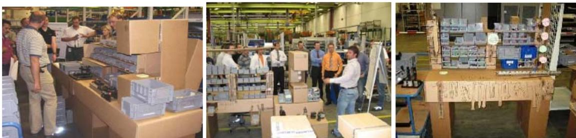
Bild 186: Aufbau der Kartonagen für das zukünftige Montagesystem
