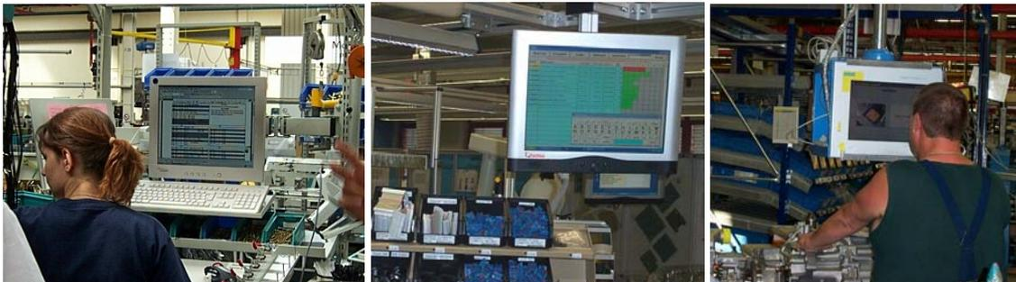
Bilder 167 a-c: Elektronisch bereitgestellte Auftragspapiere (Stücklisten, Auftragsreihenfolge, Montageanweisung, usw.)
