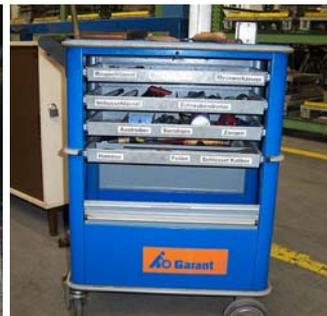
**Bild 68:** Beschriftung und Zuordnung im Rüstwagen
