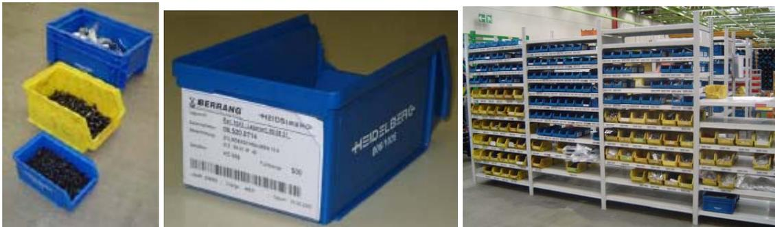
**Bild 142: C-Teile-Management durch externen Dienstleister (angepasste Behälter, Scannfähige Kanban-Karten, Regal im Montagebereich nach Häufigkeit der Entnahme geordnet (Quelle: Heidelberger Druckmaschinen AG)**
