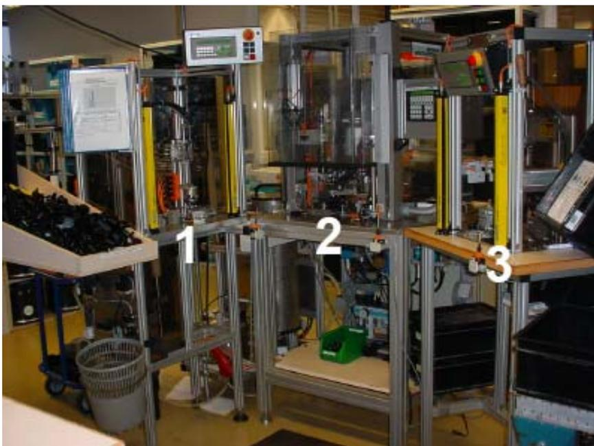
Bild 7: Zusammenfassen von Arbeitsgängen in einem Arbeitssystem
