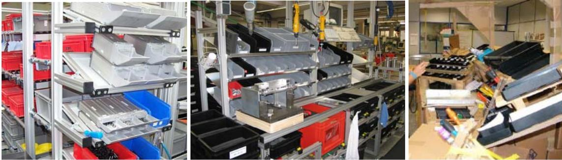
**Bild 52 a-c: Beispiele unterschiedlicher griffnaher Anordnungen von zu verbauendem Material Simulation am Kartonage-Modell**
