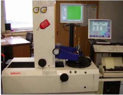
Bild 113: Einstelldaten direkt in die Maschine überspielen
