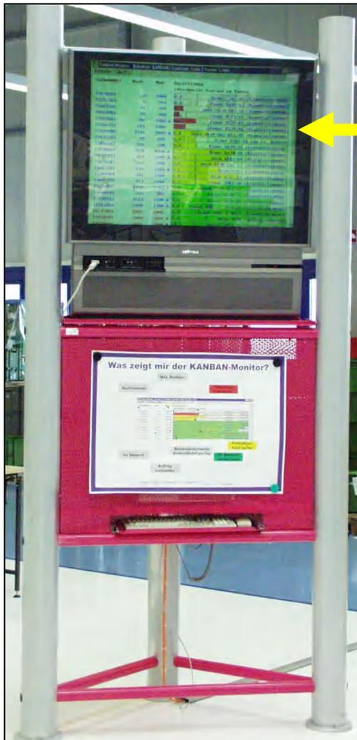
Zur Selbststeuerung der LP-Vorfertigung sind KANBAN-Monitore installiert
