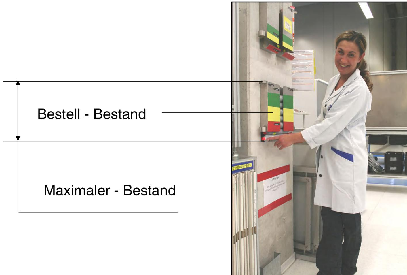
Mit dieser „KANBAN“- Lösung wurde gleichzeitig das Problem der zeitlich begrenzten Verwendungsfähigkeit der Paste gelöst.
