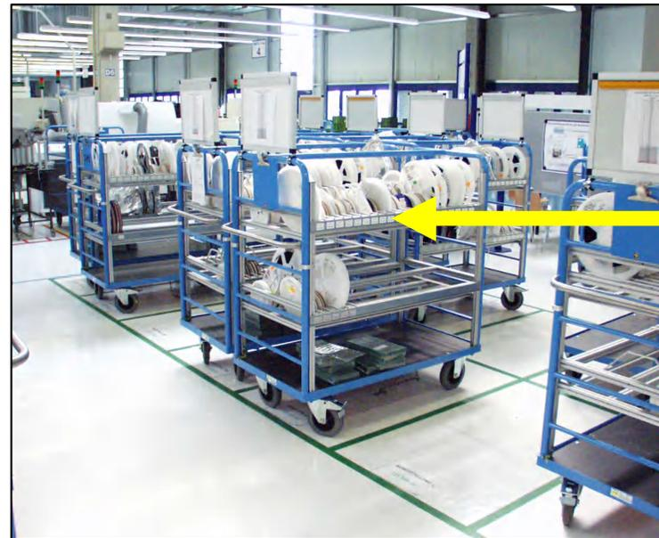
Für ALLE zu fertigenden Baugruppen ist auf Bereitstellwagen eine Grundausstattung von Bauteilen in der Produktion
