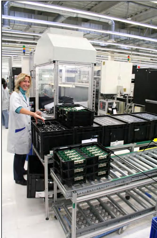
Die Bereitstellungsflächen am Montagesystem ( FMS ) definieren den max. Teilebestand
