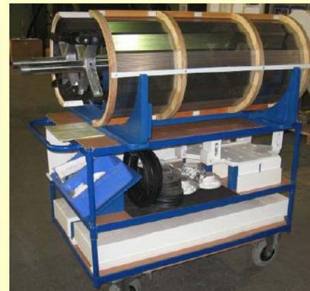
**Minomi** bezeichnet ein Verfahren, bei dem die produzierten Teile gleich auf ein mobiles Rollgestell aufgehängt werden und ohne Zwischenlagerung und Mehrfachhandling via Tugger oder händisch weiter geschoben werden.
