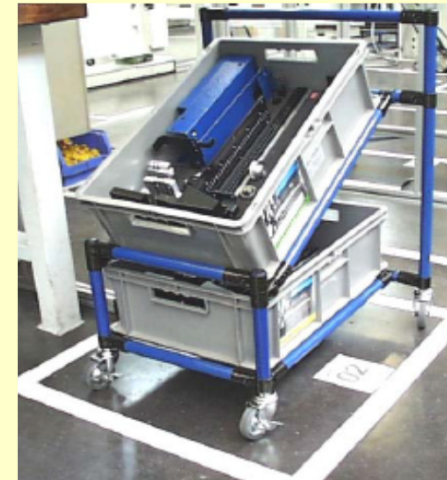
Einzelatzfluss: der Montage steht nur 2 Sätze zur Verfügung. Anlieferung durch Lieferant täglich
