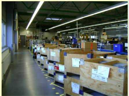
Nachher: Das Material wurde so ausgerichtet, dass das Material in der logischen Reihenfolge einfach und ohne Verschwendung zu entnehmen ist.
