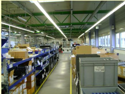
Regale wurden gekürzt, so dass alle Mitarbeiter ohne Hilfsmittel das Material entnehmen können. Jeder Behälter ist jetzt einsehbar. Teile wurden nach Häufigkeit im Verbrauch geordnet. Häufigste Teile montagenah.
