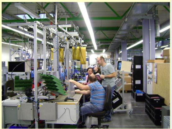
Nachher: Genügend Platz für die Montage, das Material wird jetzt separat in einem Supermarkt gelagert. Die Montage wird durch ein Linien-Logistiker versorgt.
