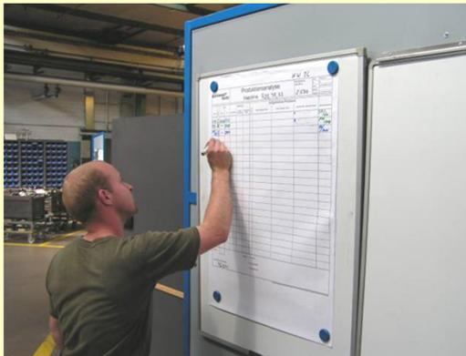
Erfassen aller Maschinenstillstände mittels Produktionsanalyse: Hier ist es wichtig, dass die Störungen genau beschrieben werden und die Stillstandszeiten festgehalten werden.
