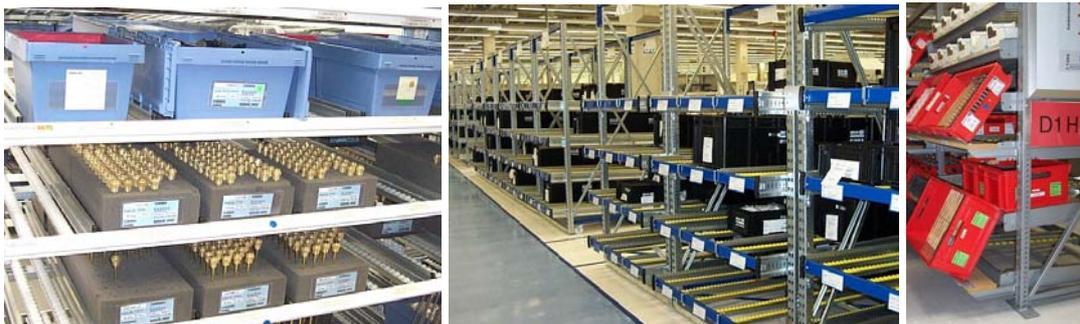
Warenhäuser (Supermarkt) aus der Teilefertigung für Entnahme durch die Montage
