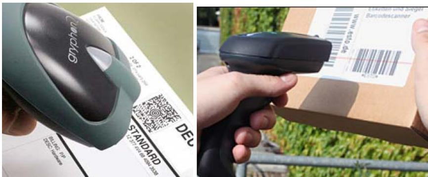
Die Barcodescanner-Typen: Grundsätzlich unterscheidet man bei Barcodescanner zwischen **CCD-Scanner** und **Laserscanner**.
