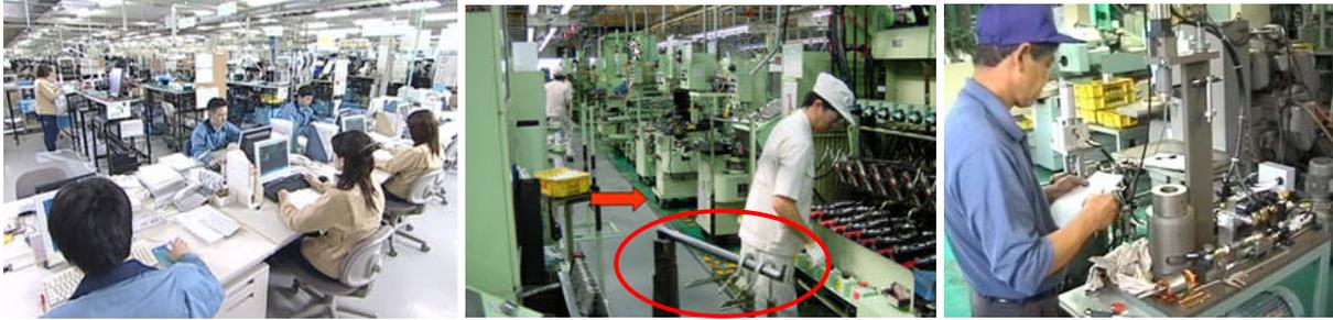
**Bild 1: Low Cost: Planer in der Produktion (schneller Zugriff bei Problemen); Bild 2: Einfachstautomatisierung: Schwenkarm für Maschinenwechsel; Bild 3: Einfachsvorrichtung**
