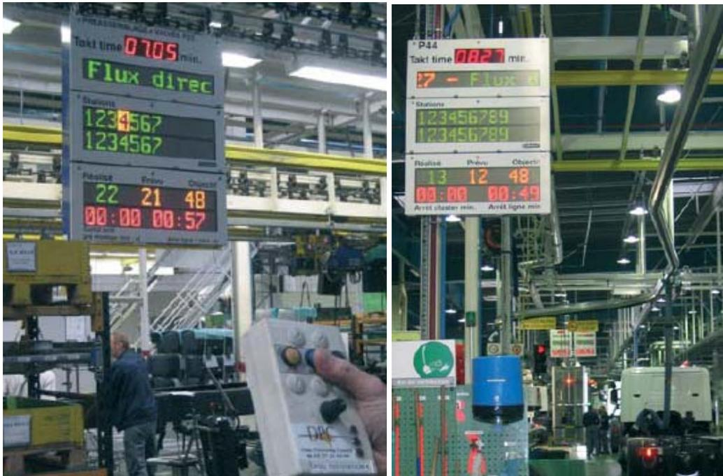
Andon-Boards sind kundenspezifisch konzipiert und stellen in Echtzeit alle relevanten Daten über den Produktions- und Logistikzustand dar: Ist, Soll, Trend, sowie andere Informationen (Leistung, Lagerbestand, Datum, Uhrzeit, usw.). Jedes Andon-Board wird von einer eigenen Recheneinheit gesteuert. Eine besondere Software ermöglicht die Änderung der Parametrierung (z.B. Produktionskalender) durch die direkte Verbindung (Ethernet) zwischen einem Laptop und der Recheneinheit.
