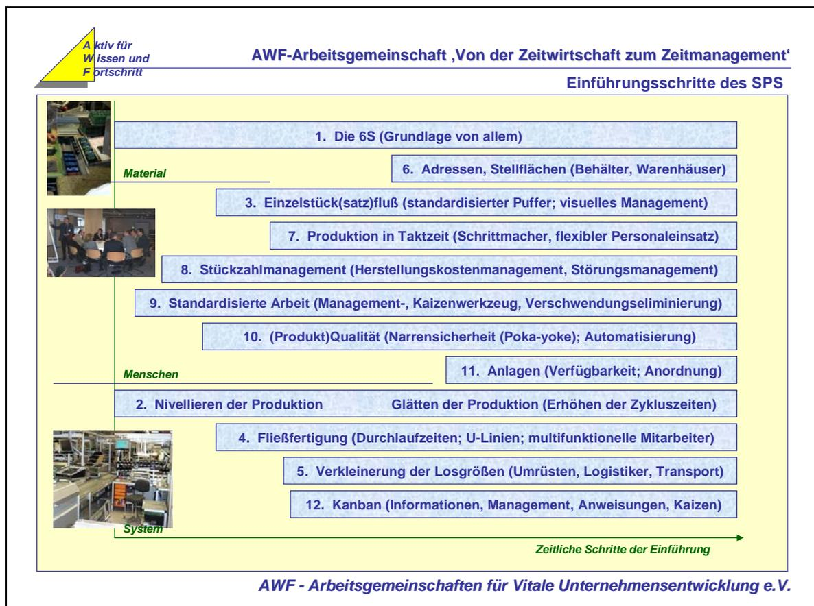
Die Einführungsschritte des Synchronen Produktionssystems
